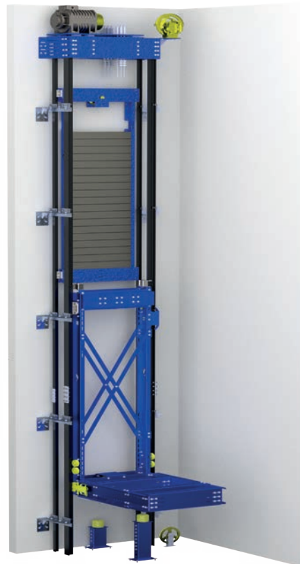
MRL-L: Modelo de chasis de cabina L.
